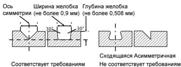
Рисунок 15. Требования к форме желобков
