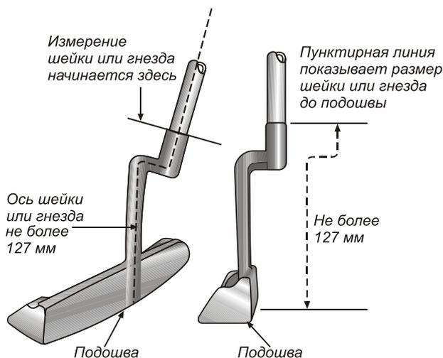
Рисунок 10. Измерение длины шейки
