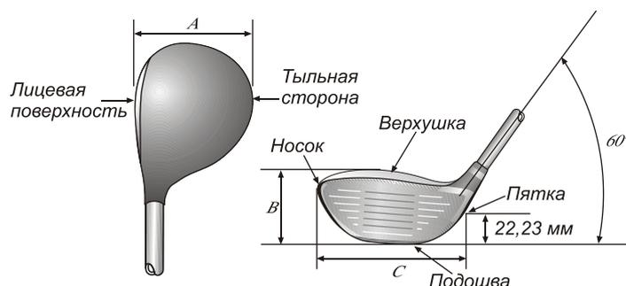
Рисунок 12. Измерение головки вуда
