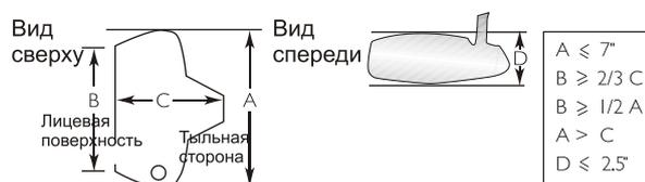
Рисунок 13. Требования к размерам головки паттера
